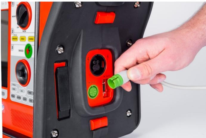
**Abbildung 9: EKG-Kabelanschluss - Übereinstimmung der mechanischen Codierung von Stecker und Buchse**
